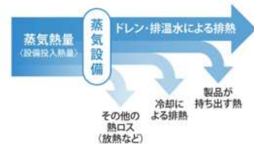
図 蒸気利用設備の熱収支関係
